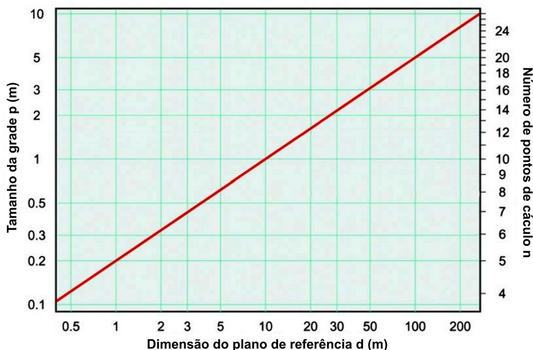
Figura B.1 – Tamanho de grade em função das dimensões do plano de referência
